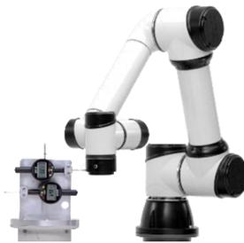
机器人重复定位测试
