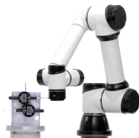
机器人重复定位测试
