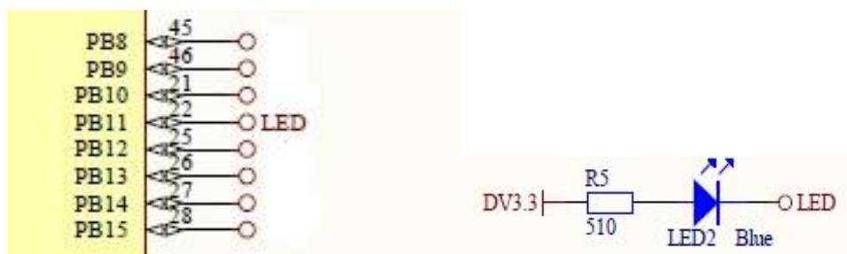
图 4.1.1 LED 灯与 STM32f103CB 连接电路
