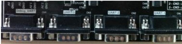
关于根节点串口的连接选择是复用的，可以使用相应根节点下方的 4 位拨码开关 1234，其中 123 位分别对应根节点与 Cortex-A53 相应串口的连接，4 用于根节点与 Debug UART 串口的连接。同一时间，只能有一个根节点使用 Debug UART 串口，如果串口使用出错，相应的 UART ERROR 串口指示灯会点亮。
