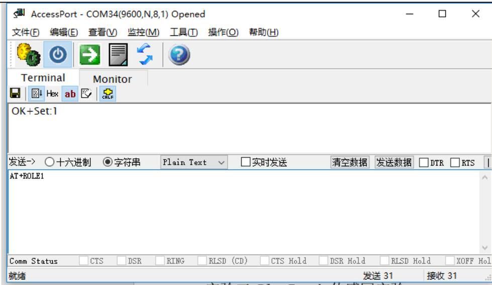
此时等待蓝牙模块自动搜索从机连接，如果长时间无法连接有可能是模块默认不自动搜索设备，需要更改，发送 AT+FILTO。
