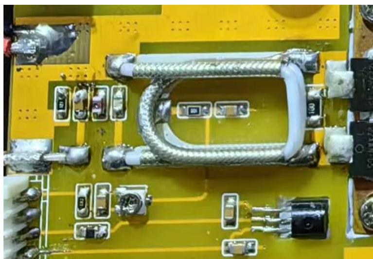
在功率管末级电路中，常见的电路形式是把推挽对称输出变换为非对称输出，电路原理图如下：
